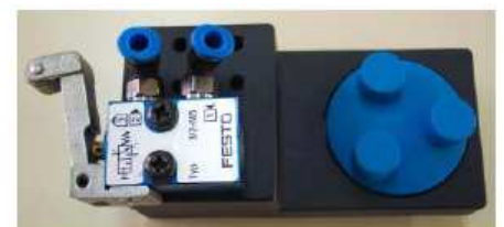
Válvula 3/2 final de carrera/muelle
